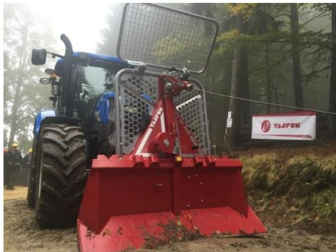
Verricello forestale elettroidraulico con meccanismo di espulsione fune combinato con freno in entrata e telecomando elettrico a pulsanti
