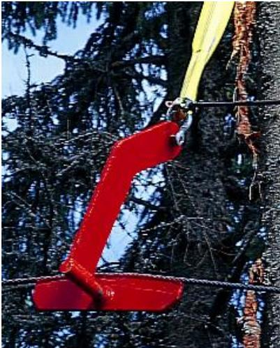
Carrello pescante semiautomatico SAVALL 1500 con campana di aggancio oscillante, completo di stazioni di blocco di monte e valle ad ammortamento idraulico sulla fune portante, pompa idraulica manuale con relative tubazioni flessibili da 10 metri ed una scarpa di supporto per la fune portante. Funzionamento a gravità con fune portante e fune traente, carichi utili fino a 1.500 kg.
